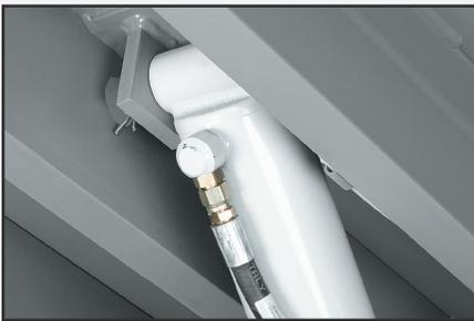
Cilindro de elevación de estilo pión invertido.
